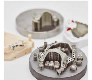
Ein neuer Drucker verspricht, 80 Zähne in weniger als drei Stunden auf einer Plattform zu produzieren. Foto Trumpf
