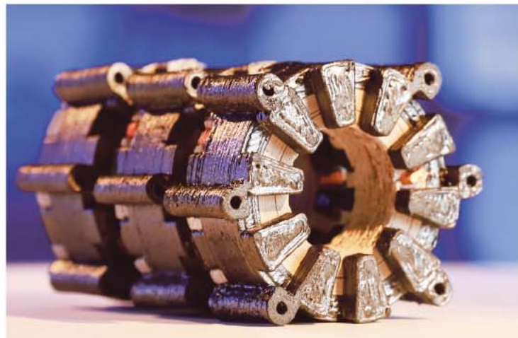
Diese Statoren einer dreiphasigen wickelkopflösen Reluktanzmaschine wurden mittels 3D-Multimaterialdruck an der TU Chemnitz hergestellt. Foto Jacob Müller
