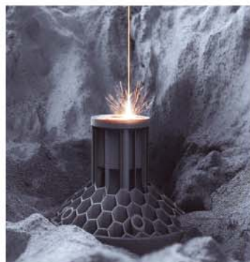
Titelfoto Generative Fertigung im Pulverbett für den hochpräzisen Aufbau mit Schichtdicken von 20 bis 100µm. Foto DMG Mori
