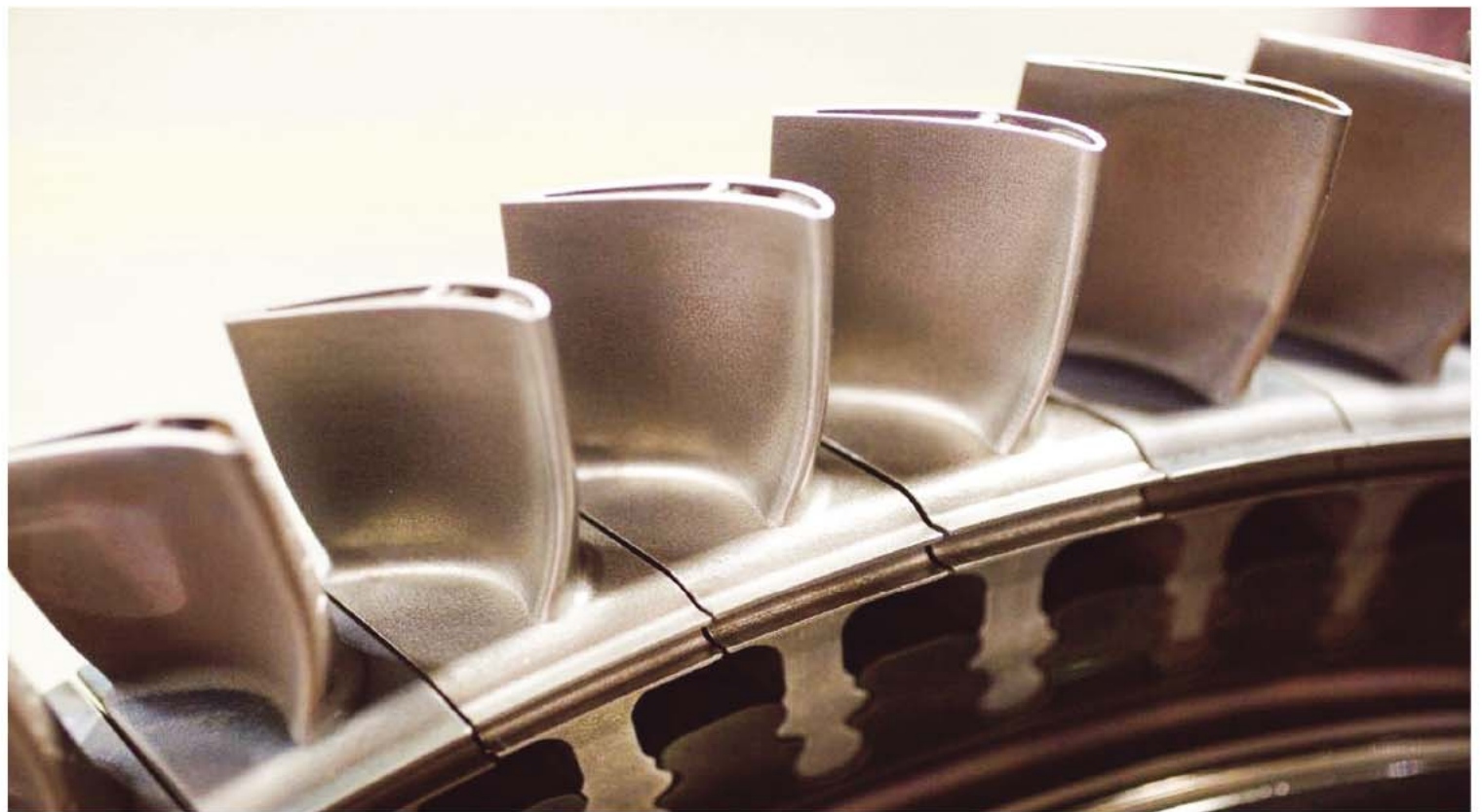
Für Siemens ein Durchbruch: Die ersten vollständig mittels Additive Manufacturing gefertigten Gasturbinenschaufeln haben die Tests unter Vollastbedingungen erfolgreich bestanden. Die Schaufeln waren 13.000 Umdrehungen in der Minute und Temperaturen von über 1.250 Grad Celsius ausgesetzt. Foto Siemens
